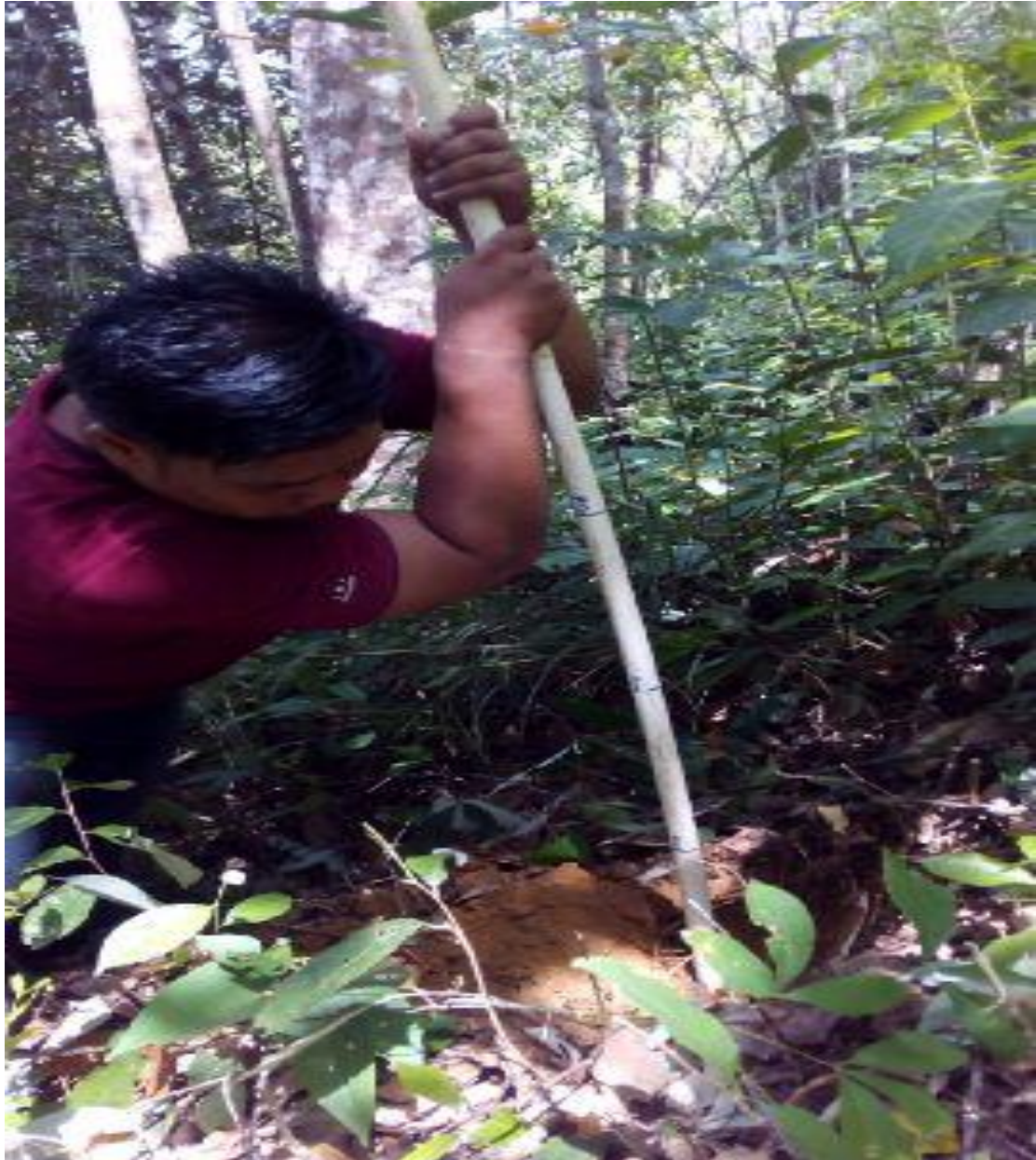
Gambar 4.7. Pengambilan Sampel Tanah Hingga Kedalaman 75 cm
